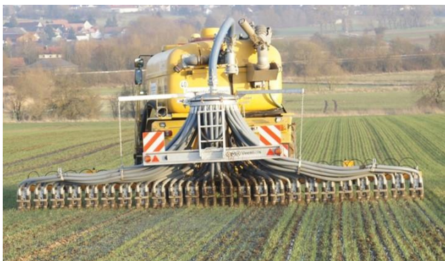
Abbildung 3: Durch Einschlitzen von Gülle in Winterweizen werden Ammoniakemissionen vermindert und die Nährstoffe direkt im Wurzelraum der Pflanzen abgelegt.
