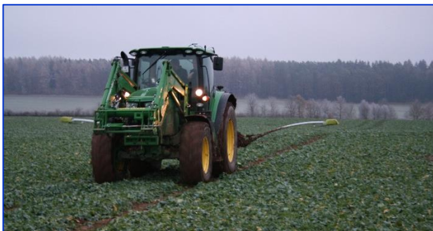
Scannen eines Rapsbestandes im Herbst (Claas Crop Sensor)
