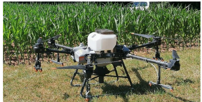
Drohne zur Ausbringung von Untersaaten im Mais. Die spätere Ausbringung von Untersaaten aus der Luft in den stehenden Mais bringt den Vorteil, dass Bodenherbizide bereits abgebaut sind.
