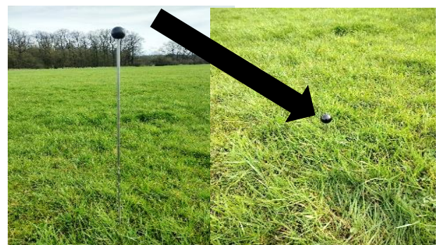
Abb.1: Mit einer Bodensonde können Sie leicht Verdichtungen auf Ihrem Grünland feststellen. In diesem Fall drang die Sonde bis 1 m Tiefe bereits mit leichtem Druck in den Boden ein. Es liegt keine Verdichtung vor, welche die Wurzeln nicht durchdringen könnten.
