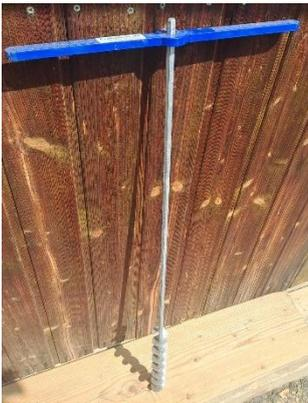
**Abb. 4:** Erdbohreraufsatz für den Akkuschauber, der Handgriff kann abmontiert werden.
