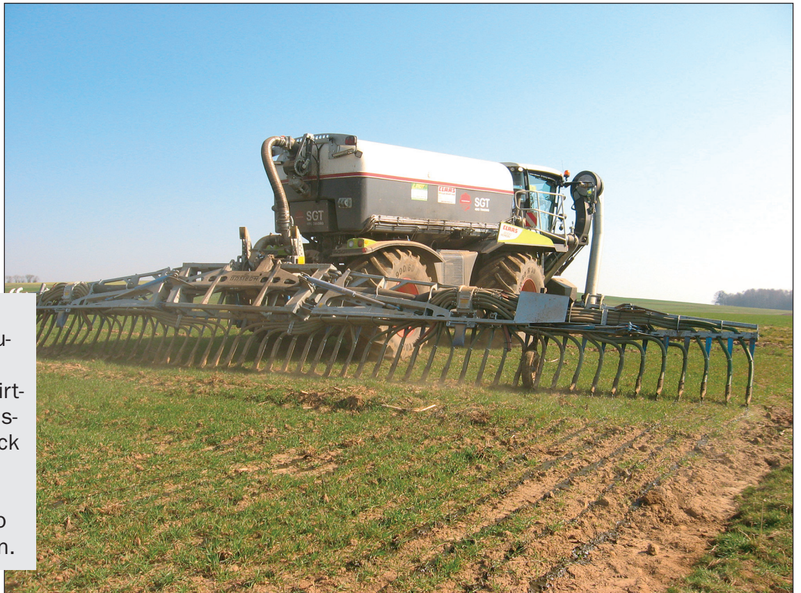
Frühe Ausbringung der Gülle mit dem Schleppschuhverteiler in das Wintergetreide führt zu einer hohen Stickstoffeffizienz und weniger Grundwasserbelastung.
